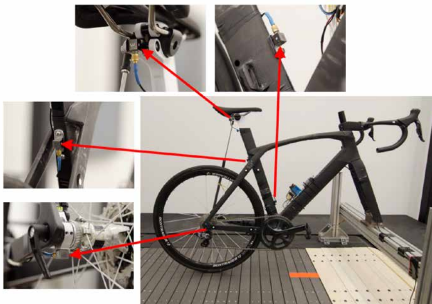
図 A4. 各部に取り付けた3軸加速度計
