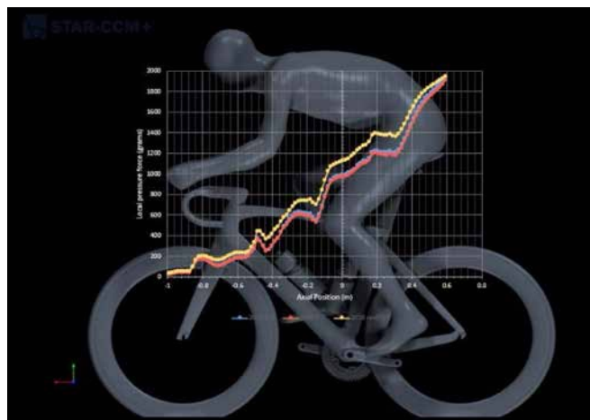
図1. 第1作目から最終版までのデザイン反復プロセスにおける、CFD シミュレーション（局所のおよび蓄積した力と軸となる位置との関係）（黄 - 新型Madone 第1作目、青 - 前Madone、赤 - 新型Madone最終版）
